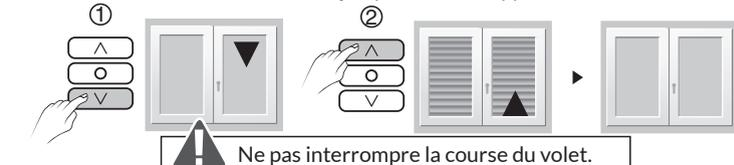
**Remarque :** L'apprentissage des temps de courses du volet, s'ajuste automatiquement à chaque cycle complet de butée à butée. Si la puissance du moteur raccordé est inférieure à 45W, réalisez cette opération manuellement (voir notice complémentaire présente sur les pages TYXIA 5630 - 5730 du site DELTA DORE).
