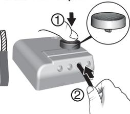
A l'aide de l'outil fourni ou d'un tournevis de 2,5 mm, appuyez sur le bouton de la borne puis insérez le fil.
